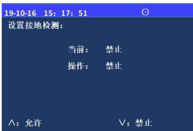
图4.3.6 设置接地检测
