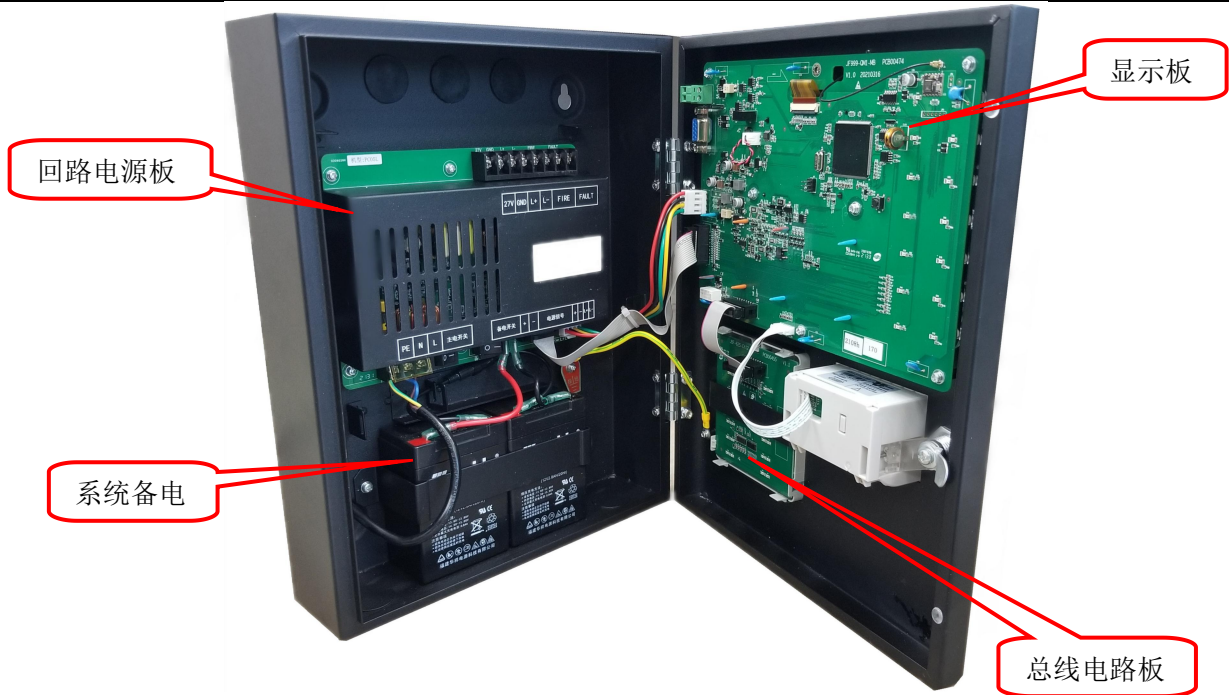
图 1.5 监控器内部结构图
